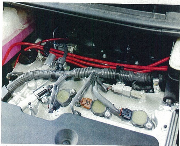
これがシステムアップキットも装着した完成状態。3本中、2本はエンジンヘッド片バンクそれぞれに、もう1本はオルタネーターに接続している。これで恐らく電気系は抜かりなし状態はず。
